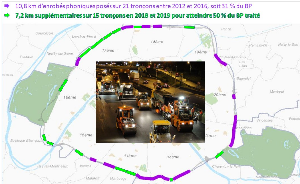
Figure 18 : Avancée du recouvrement du Boulevard Périphérique par un enrobé phonique (source : AEU, 2018)
